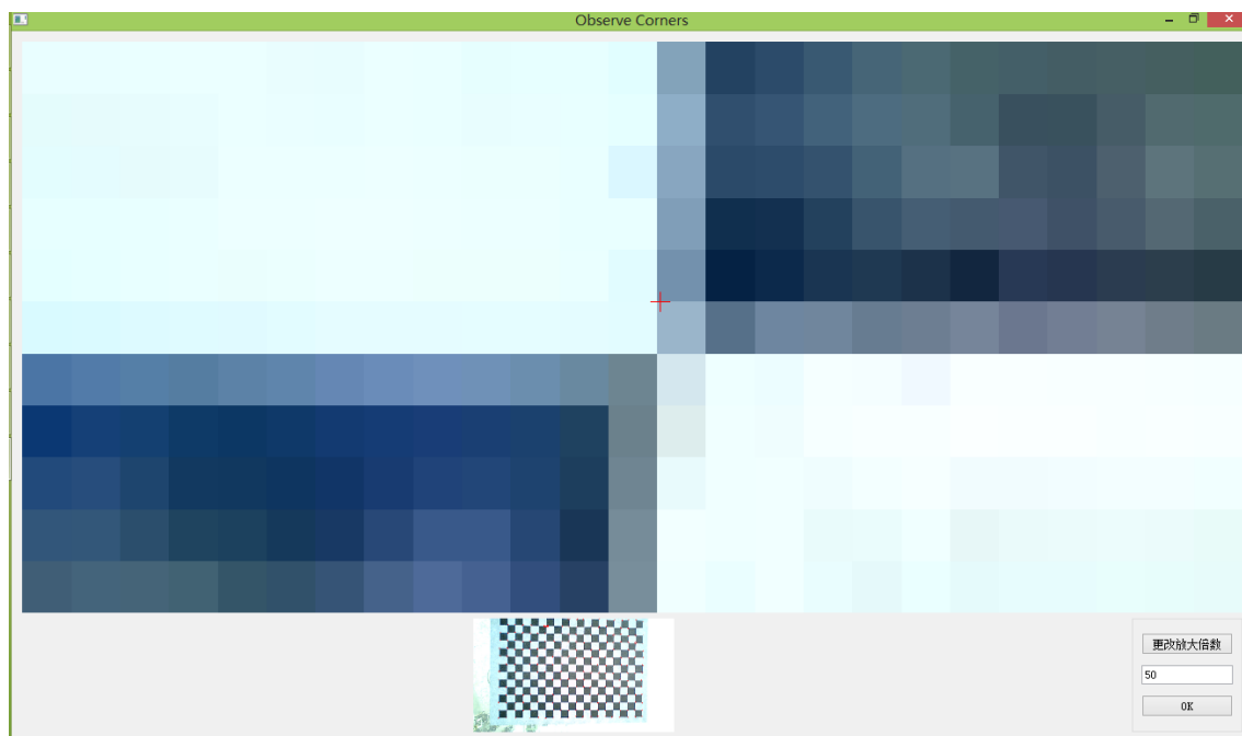
图 2.19 采用二次平面拟合提取亚像素角点 上为局部放大 50 倍 下为缩略图
