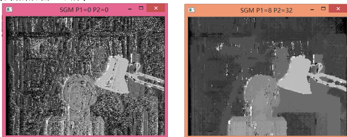
图 4.15 SGM 算法测试结果 左图 P1=P2=0 右图 P1=8 P2=32 耗时 692ms
