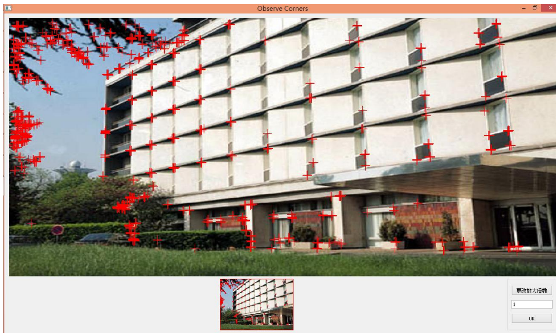
图 2.15 Nobel 角点提取算法 threshold= 8000
